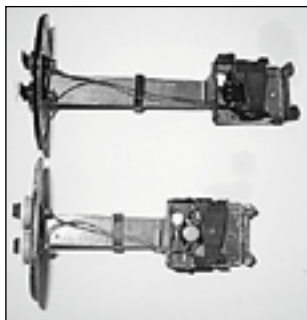
Bild 2. Sonettens givare sitter djupare i tanken. Enheten är 25 mm längre än motsvarande i Saab 96 V4.
