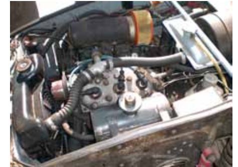
Motorn är kompletterad med ett AC-aggregat.
