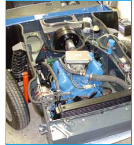
Sonettens motorrum med Ford V4 motor.
