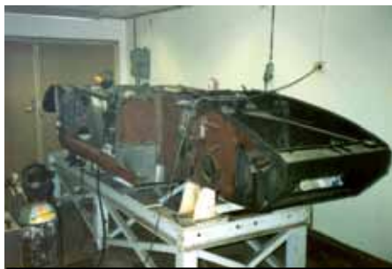
Uppstätt i riktbank för att få alla mått att stämma.
