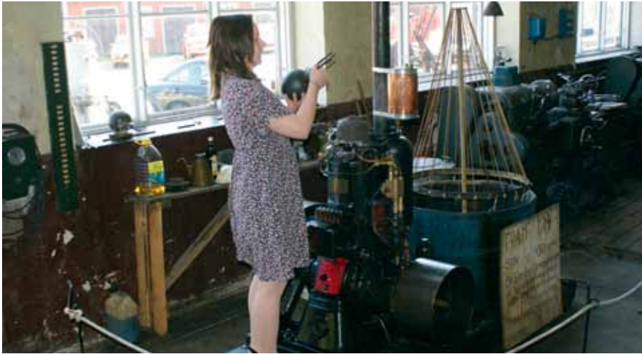
Ovan. Svärstartad tändkulemotor. Nedan. Den stora motorn i drift.
