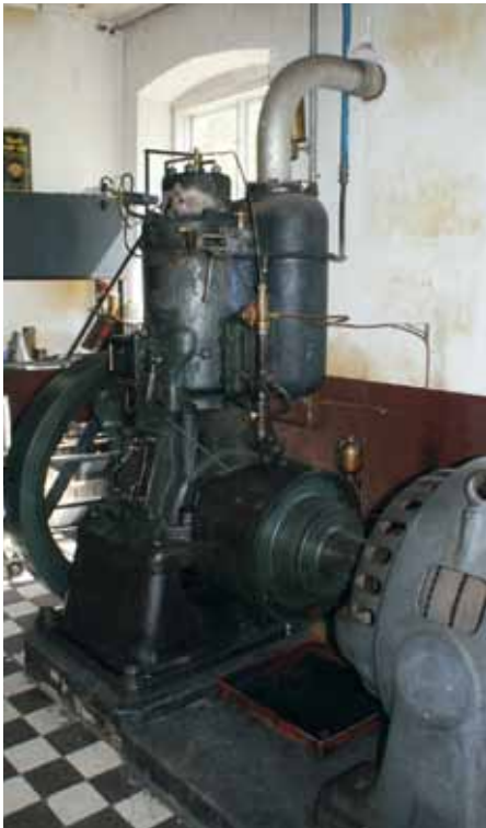
Ovan. Svärstartad tändkulemotor. Nedan. Den stora motorn i drift.
