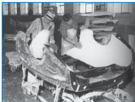
Bilarnas plastkarosser tillverkades hantverksmässigt med hjälp av stora formar.
