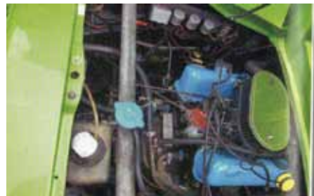
Unten: Robuster V4-Motor aus dem Ford 17M.
