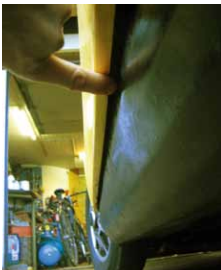
Dørpladen skal være parallel med panelet, når døren er korrekt monteret
