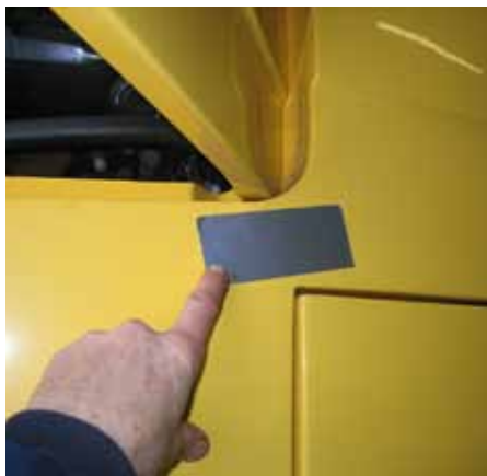
Rusten stål forstærkning i den gamle glasfiber skal fjernes og erstattes med rustfrit eller kevlar plade
