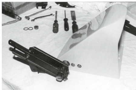
Venstre lygtehus prøve monteret, for at sikre at alle dele passer
