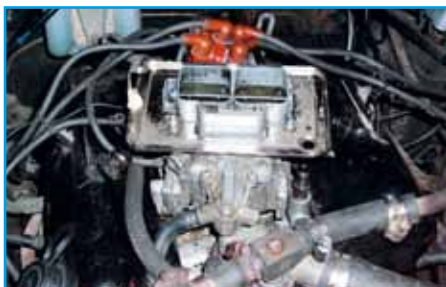
Den nästan färdiga monteringen av Weber i motorrummet.
