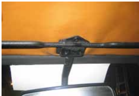
Indvendigt bakspejl og ophæng for solskærm, er fastgjort i limet fiberklods
