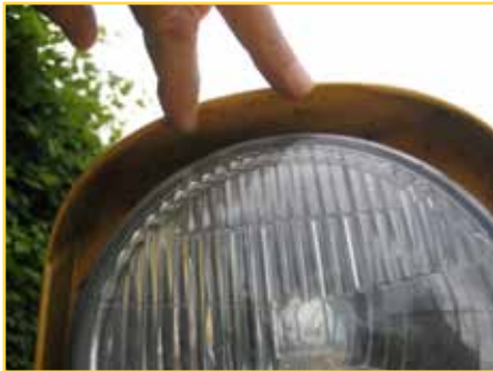
Knækket forkant pga. Manglende gummi stop.
