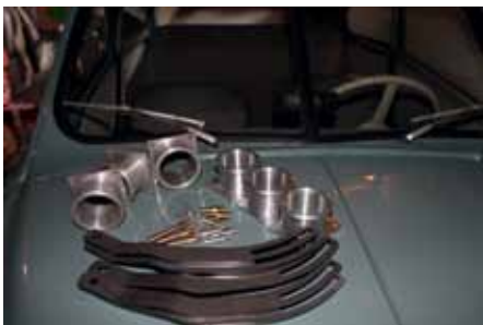
Nye generatorbeslag, "airhorns" og diverse hjemmelavede studser til karburator.
