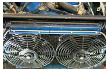
Kopparböj uppåt vänster, 88° termostat uppåt samt 12" elfkläktar.
