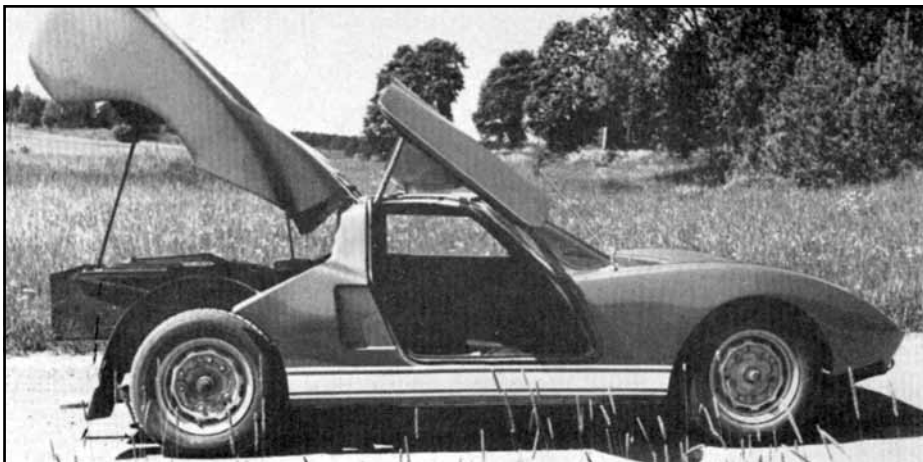
Piraya är en intressant nykomling av en nykomling i bilbyggerbranschen, Racingplast i Burträsk. Vagnen är uppfällbar på alla håll och kanter för att göra motor och växellåda lätt åtkomliga för service och underhåll.
