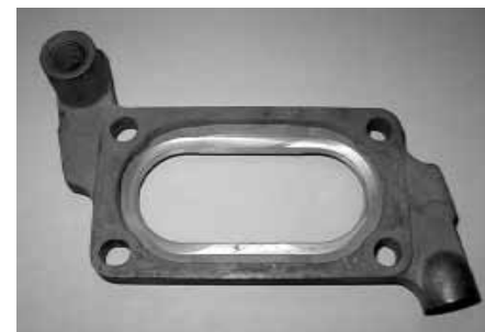
Mellanplatta Saab Sporter Rally No 15750. Ursprunget är en vanlig mellanplatta till en Solex 32/32TDID.
