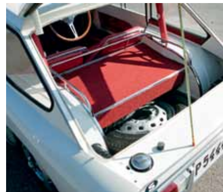
Kromkantade inre hjulhus och elegant ränna för att hålla reseffekterna på plats. Bakluckan öppnar generöst, hela karossens bredd.
