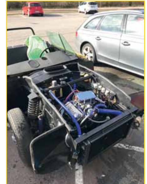
Ny motor monterad. Ventilkåpor i aluminium med Sonett ingjutet, från Irland
