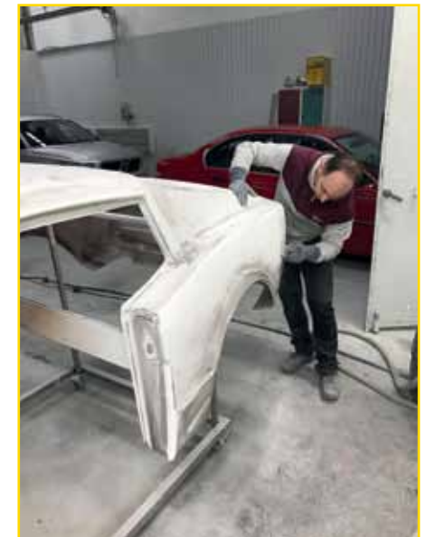
Ännu en nedslipning av karossen efter grundning
