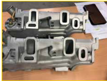
Original insugningsrör och det filade som monterats på motorn.
