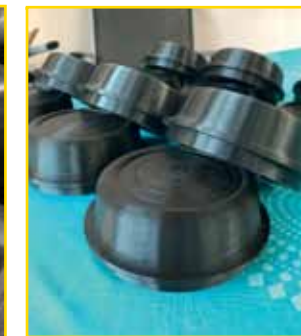
Nyttillverkade, modifierade, 3D-printade centrumkåpor
