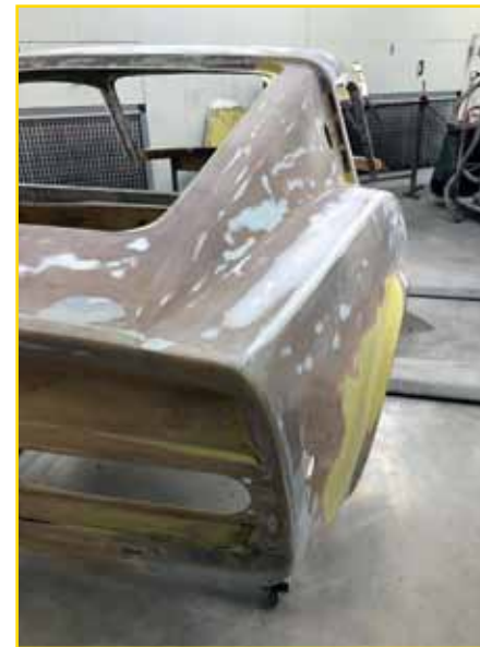
Första nedslipningen av karossen efter lagning av alla sprickor
