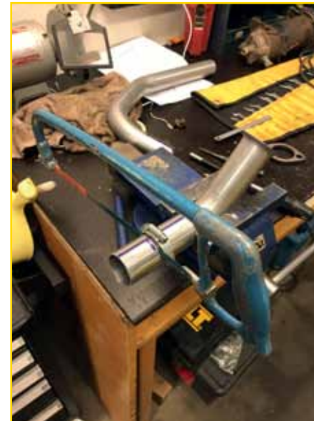
Anpassning av Saabs SSR 2 tumssystem för bättre anpassning mot karossen
