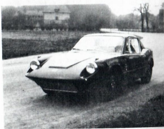
De första 10 bilarna hade en "grill" av ett metallnät, se bilderna t v. Senare kom "fotskrapan" — dock redan på vissa förseriebilar.
