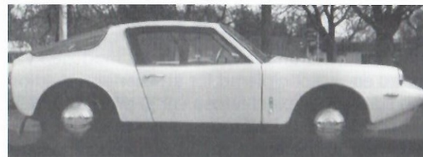
MFI-13 var den prototyp som togs fram av Malmö flygindustri och tillverkades i plåt
