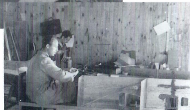
Elis Olsson och Sven Fredriksson putsar trägipsmodellen vilken användes som modell för plastkarossen. Bilden är tagen i ladan i Åsaka 1955.
