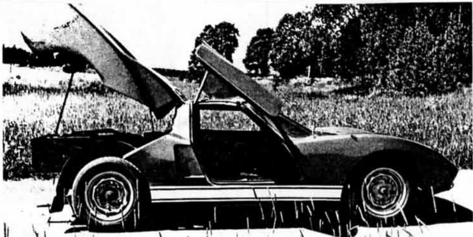
■ Piraya är en intressant nykomling av en nykomling i bilbyggjarbranschen, Racingplast i Burträsk. Vagnen är upplåbar på alla håll och kanter för att göra motor och växellåda lätt åtkomliga för service och underhåll.
