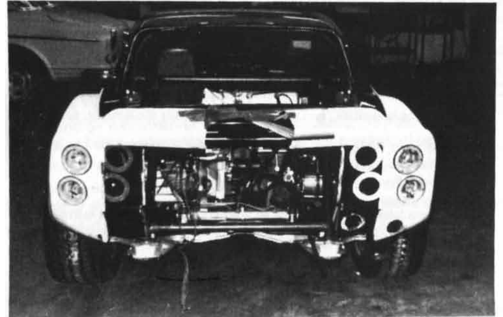
Bakre delen av karossen delades och skarvas i på mitten för att räckta till i bredd över det bredare motorpaketet från Saab 9000.
