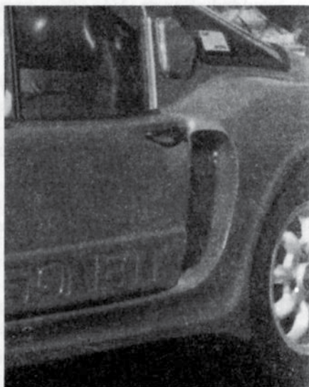
Luftintaget till den modifierade kylaren från Saab 96
