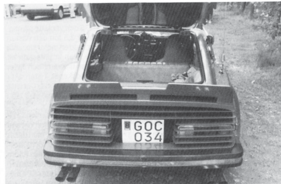
Den bakre spoilern är kraftig. Här kan man även se modifierat luftutsläpp, det specialgjorda bakrutejalousiet och gallret för bakljusen.
