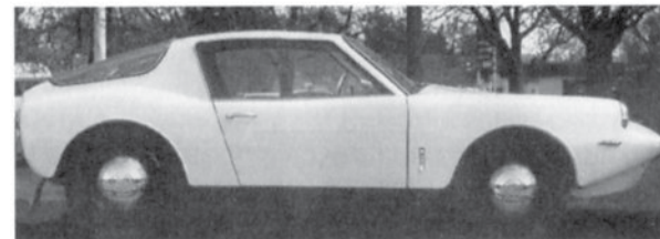
MFI-13 var den prototyp som togs fram av Malmö flygindustri och tillverkas i plåt
