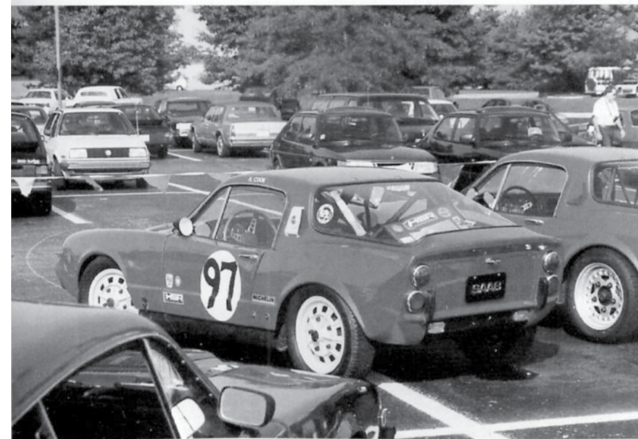
Randy Cooks Sonett-68. Detta är inte vad ni tror. Det är ingen V4 i den. Det är en tvåtaktare och den används till historisk racing. I bakgrunden syns ch. nr. 000.211.
