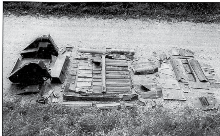
Ett exempel på hur mycket plåt som kan behöva bytas vid en Sonettrenovering. Den här bilen var inte exceptionellt dålig utan hade dåliga trösklar samt spaltrost i lågt placerade svetsfogar. Dessutom hade den bristfälligt reparerade krockskador i fram respektive bakparti. (Rätt gissat, det är er skribents tvåtaktssonett)
