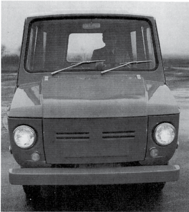
Elbil byggd på Sonettchassie av MFI våren 1972 på Bulltofta. Karossen är en variant av Kalmarbilen "Tjorven". Elbilens motoreffekt var 15 kw och den var försedd med Laycock överväxel. Hastigheten var ca. 60 km/tim. Beställare var Westinghouse i USA. Bilen kallades för W 1. Byggtid 5 månader, leveransdatum 28 februari 1972. Nils Hedberg sitter vid ratten på leveransdagen. Bildtext av ing. Bo Düner.
