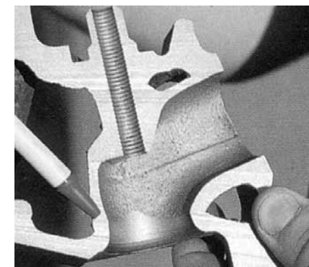
Bilden visar ett uppsågat topplock där man kan se hur ventilsätet har förstörts vid spetsen på pennan.
