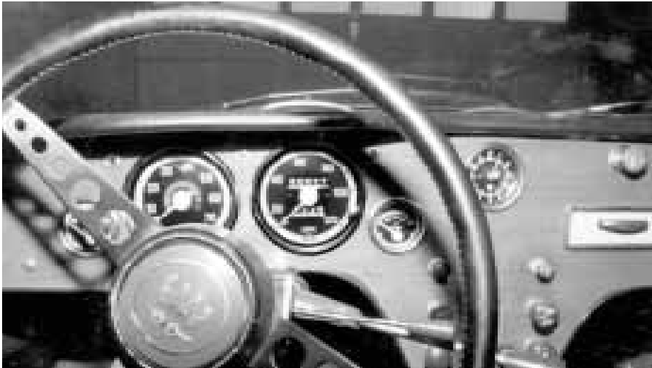
Bilden föreställer milesmätaren i chassinummer 168. W-konstanten finns stansad på baksidan av instrumenthusen.
