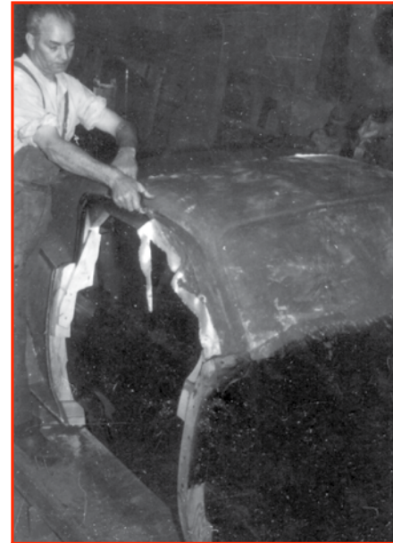
Tillverkning av gjutformar för karossen var ett grannlaga jobb. Bilderna visar "handpåläggning" av glasfiber mattor som sedan ströks med flytande plast. Förutom passform skulle formarna förstärkas så de höll formen och inte skevade och blev sneda, så förstärkningar lades in på lämpliga ställen på formarna!
