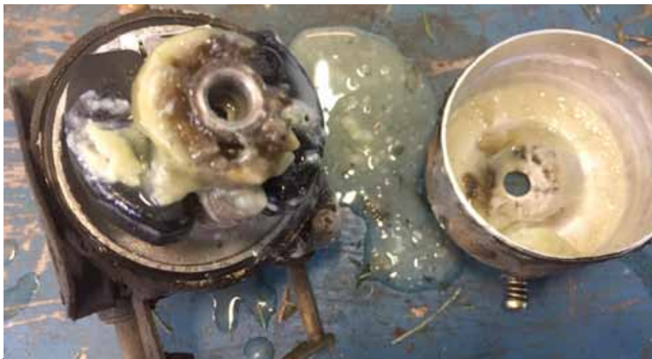
Oxidationsprocessen i full gång, "Gumming"
