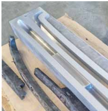
Ovan. Möte med Speedtool och Habo Gummiprodukter Nedan. Planfräst och slipat formverktyg
