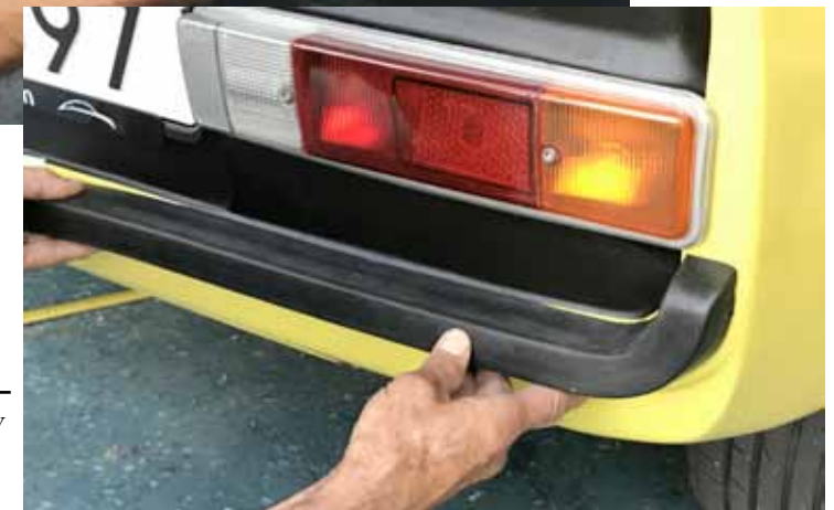
Provmontering av de nya stötfångarna
