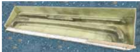
Glasfiberavgjutning av plastmodellerna
