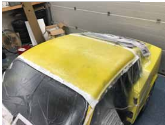
Bilen maskerad och glasfiberplast pålagd
