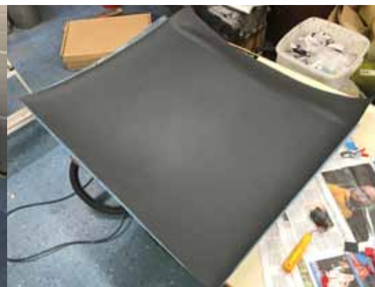
Löst innertak med pålimmad vinyl
