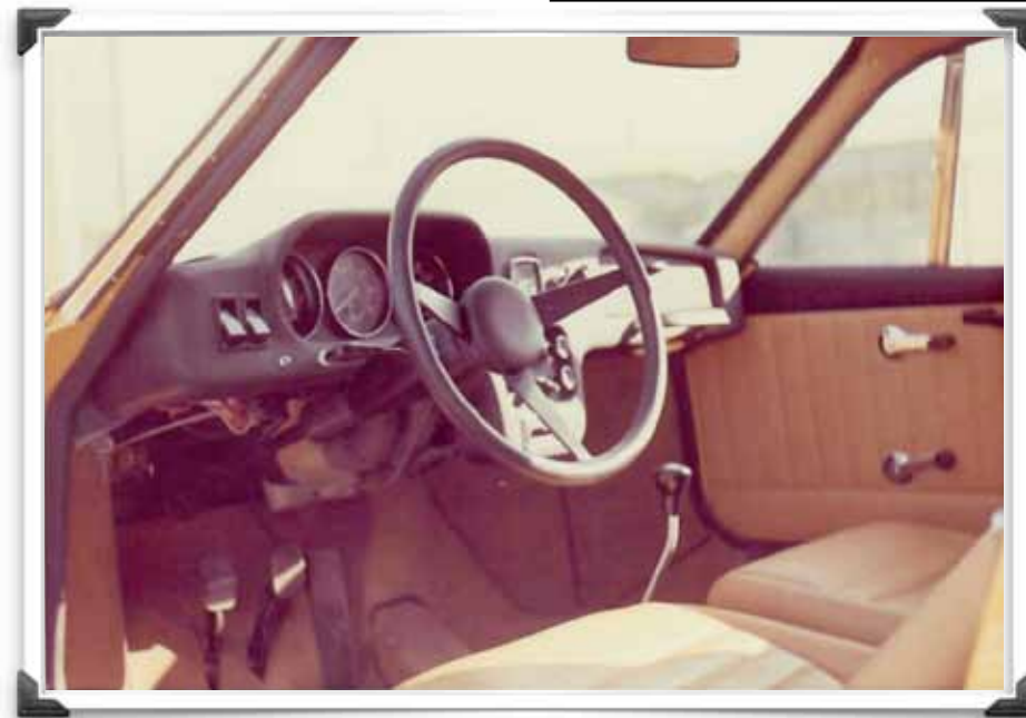
Prototyp Sonett III, interiör med böjd växelspak, sedd från förarsidan
