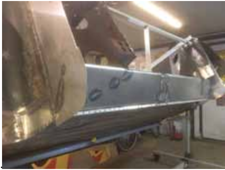
Byggede en enkel karossnurra då man inte är 20 längre. Mycket plåt och många punktsvetsar blir det!
