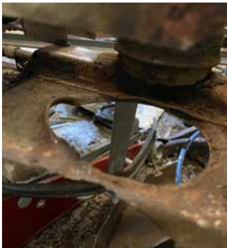
Så här ser det ofta ut i motorrummet när en gammal Saab skall rostlagas!
