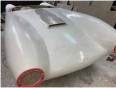
3D printade delar, hjälper till att hålla formen både till fram och baklyse.
