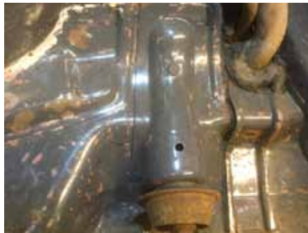
Konstigt nog är alla fyra fjäderfästen och stötdämparfästen riktigt fina.
