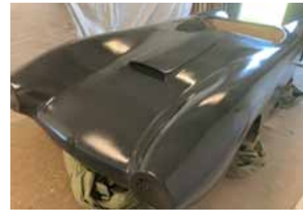
Pluggen lackas och vaxas för att kunna göra de negativa formarna till karossen.
