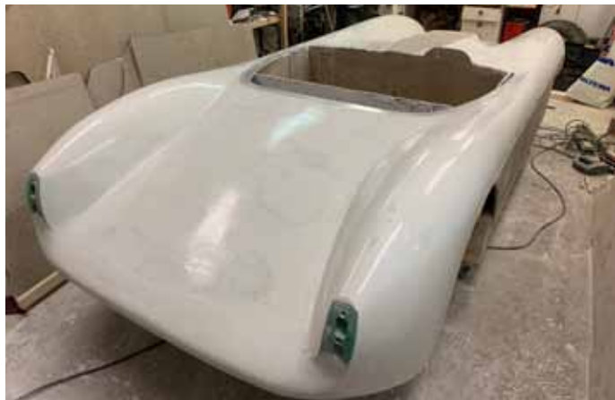
Väggspacklet fixeras med ett lager panel-lack innan ett lager glasfiber läggs på.
