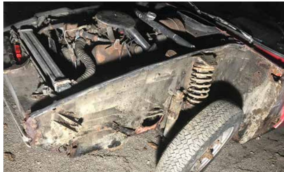
Mycket plåt att byta!
