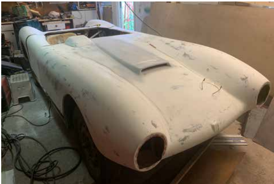
Inpassning av karosspaneler påbörjad.
