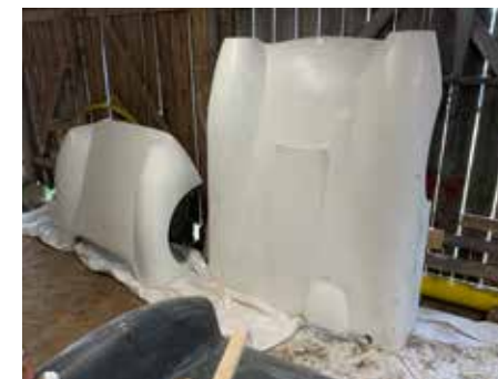
Karosspaneler direkt från gjutformen.
