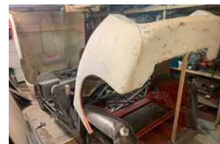
Innerskärm med inbyggd hållare för tanklocket.
